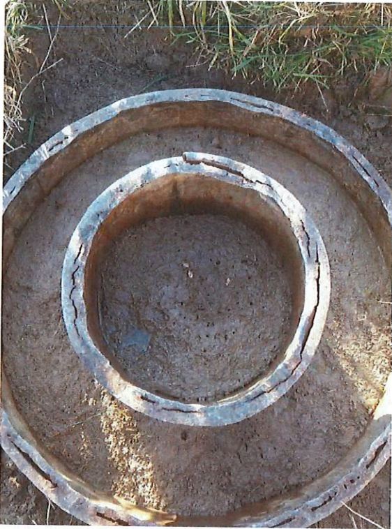
Bild 5: Versuch 3, Makroporen im Boden
