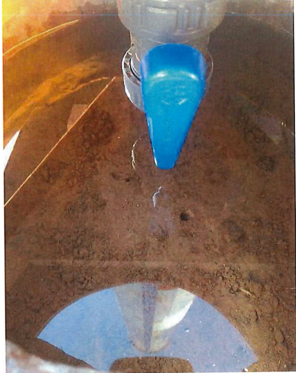
Bild 2: Versuch 1, Makroporen im Boden
