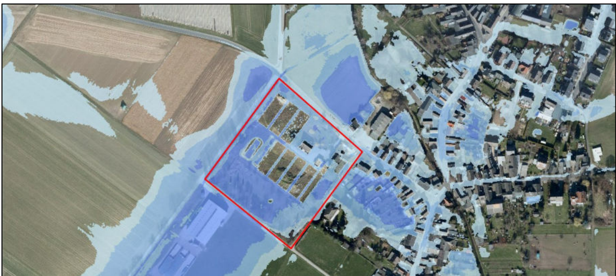
Abbildung 16: Wassertiefen bei einem extremen Starkregenereignis (Quelle: LANUV NRW)
